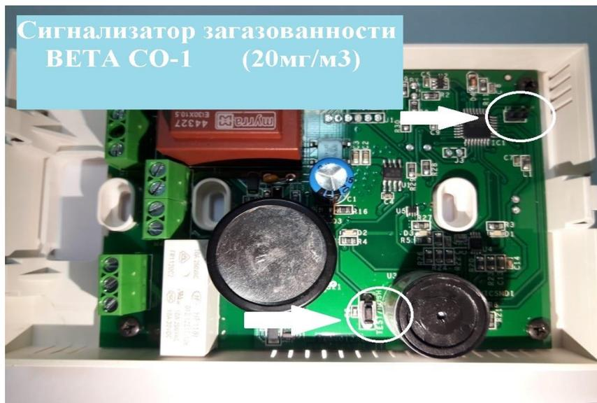
4. Отпустить кнопку TEST и снять джампер со штырей в секторе J4 (Внимание: пока данная операция не будет выполнена три светодиода будут оставаться включенными)
