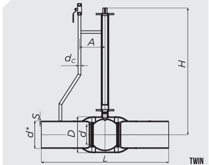
TWIN – МОДЕЛЬ С ОДНИМ ПРОДУВОЧНЫМ ПАТРУБКОМ, TRIO – МОДЕЛЬ С ДВУМЯ ПРОДУВОЧНЫМИ ПАТРУБКАМИ
