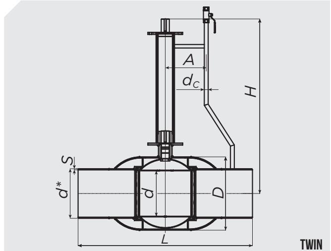
TWIN – МОДЕЛЬ С ОДНИМ ПРОДУВОЧНЫМ ПАТРУБКОМ, TRIO – МОДЕЛЬ С ДВУМЯ ПРОДУВОЧНЫМИ ПАТРУБКАМИ
