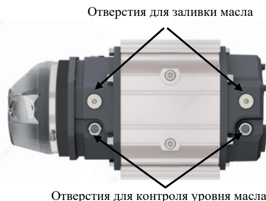
Рисунок 14 – Заливка и контроль уровня масла при установке счетчика G16-G400 на вертикальном участке трубопровода
