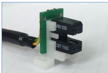
Рисунок 4. Внешний вид СЧ датчика импульсов R300
